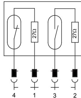
**Type de raccordement** (dispositif de protection fermé)
