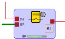
Abbildung 95: Überbrückungsblock im Modus für zeitgesteuerte Überbrückung
