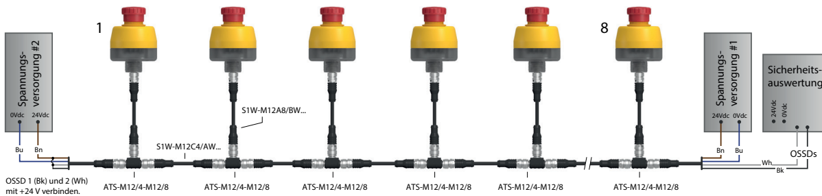
Abbildung 13. Variante 2: Endstecker durch Netzteil ersetzen. Die OSSD1- und OSSD2-Drähte des Netzteils #2 müssen an +24 V DC angeschlossen werden. Wenn möglich, richten Sie die Stromversorgungseinheiten für parallele Ausgänge ein.
