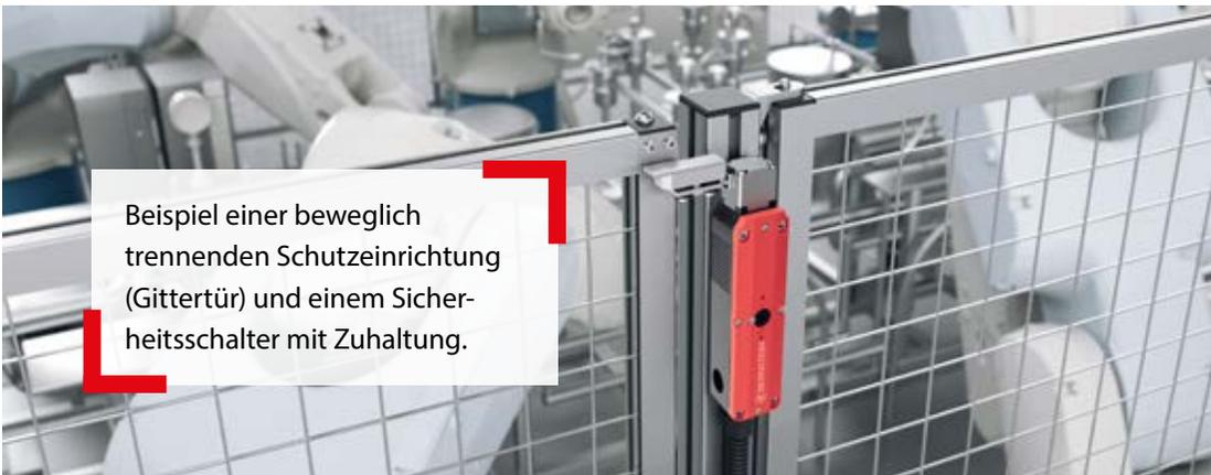
Beispiel einer beweglich trennenden Schutzeinrichtung (Gittertür) und einem Sicherheitsschalter mit Zuhaltung.
