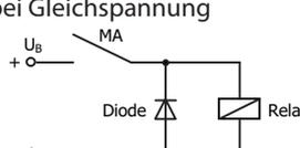
Unterdrückung von Spannungsspitzen mit einer Freilaufdiode
