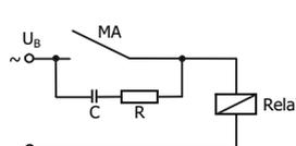
Unterdrückung von Spannungsspitzen mit einem RC-Glied
