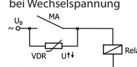
Unterdrückung von Spannungsspitzen mit einem VDR
