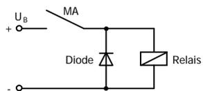
Unterdrückung von Spannungsspitzen mit einer Freilaufdiode
