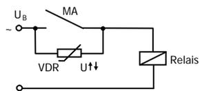
Unterdrückung von Spannungsspitzen mit einem VDR
