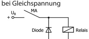
Unterdrückung von Spannungsspitzen mit einer Freilaufdiode
