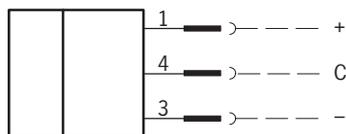
C = Control-Eingang. Wird C mit - verbunden, wird der Sender abgeschaltet (Testfunktion).
