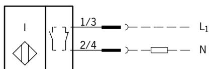
Mittels eines eingebauten Umschalters kann die Funktion Schließer oder Öffner gewählt werden.
