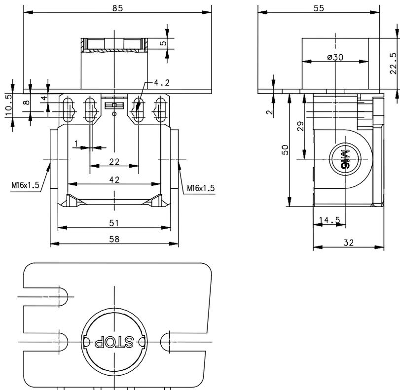
Fixierte Positionierung für Sicherheitsanwendungen
