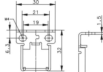
Zur manipulationssicheren Befestigung des Betätigers sind Schrauben mit Einwegkopf zu verwenden.
