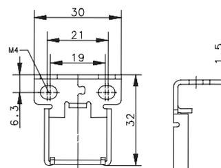
Zur manipulationssicheren Befestigung des Betätigers die beiliegenden Schrauben mit Einwegkopf verwenden (M4x8)
