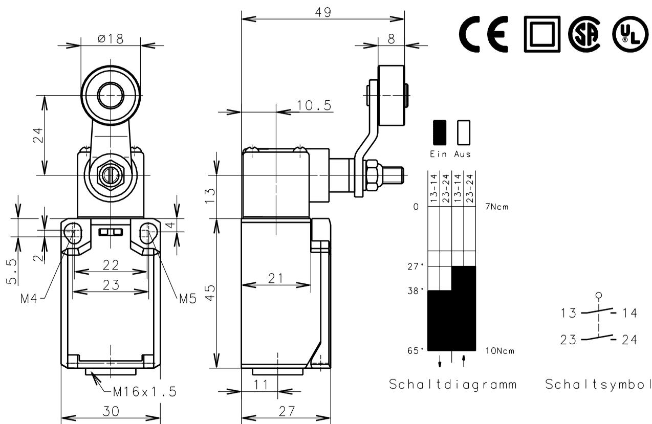
Toleranz: Schaltpunkt  $\pm 3.5^\circ$ ; Betätigungs Drehmoment  $\pm 10\%$
