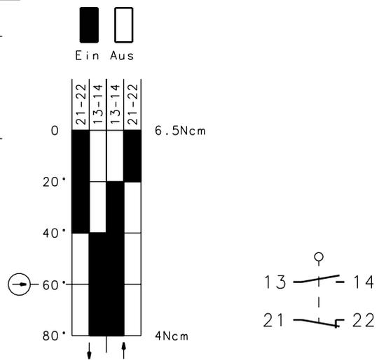
Schalt diagramm    Schaltsymbol
