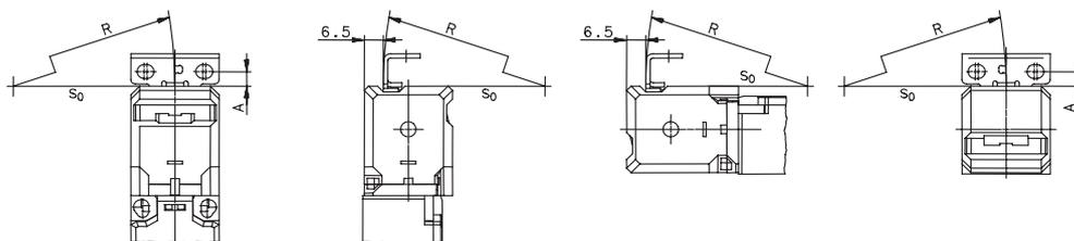
$5 \text{ mm} \leq A \leq 8 \text{ mm}$ ,  $R \geq 150 \text{ mm}$
