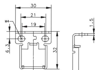
Zur manipulationssicheren Befestigung des Betätigers die beiliegenden Schrauben mit Einwegkopf verwenden (M4x8)
