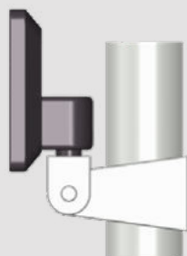
Rundrohr Ø 48 mm Anbindung von unten
